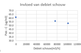
Figuur: Voorbeeld rekenblad mitigerende maatregelen. Naast de hier getoonde delen voor schermen, bermen, schouwen en een poreuze overkapping, is er ook nog een overzicht voor diepte insleuving, helling insleuving, opening in tunneldak en een vergelijking van deze mitigerende maatregelen.
